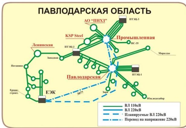
Целью реализации проекта является повышение надежности работы энергосистемы Павлодарского энергоузла путем сооружения электрической связи энергоузла с ЕЭС Казахстана на напряжении 220 кВ.
